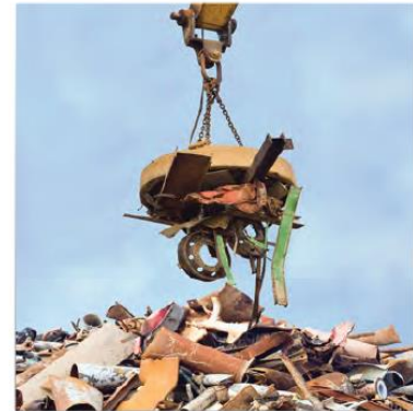
Görsel 1.88: Metal hurdaların geri dönüşüm için ayrılmasında elektromıknatıs kullanılır.
